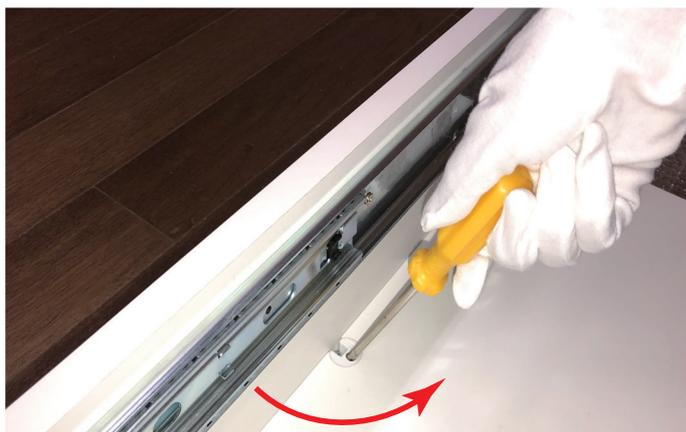
③写真の金物のネジを全て緩め側板と天板を分離します。
